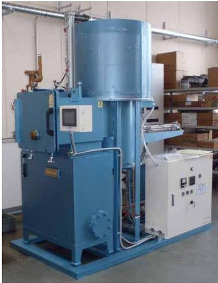
金属熱処理炉
